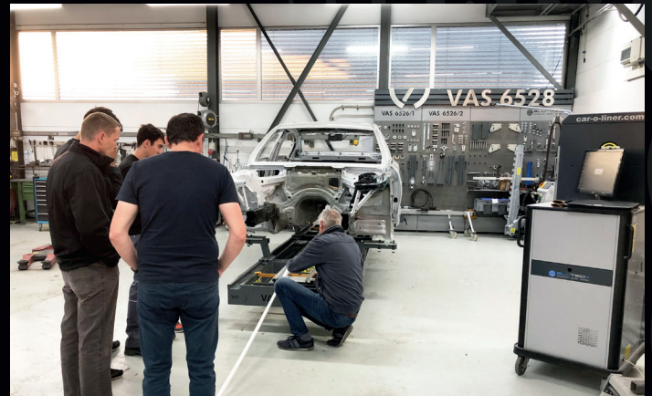
Das elektronische Karosserievermessungssystem Caroliner Vision X5
