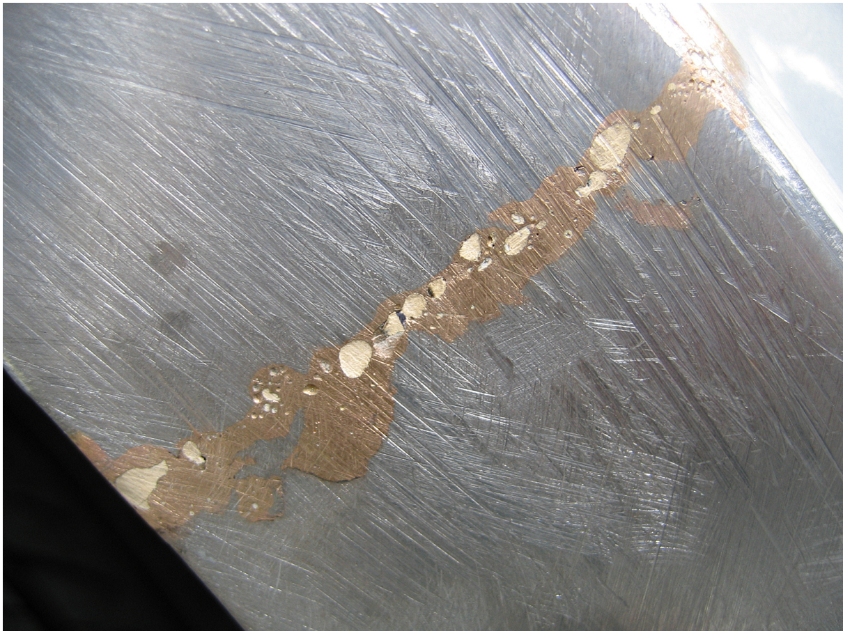
Mangelhafter Ersatz einer Seitenwand mit nicht freigegebener und unfachmännischer MIG-Lötung bei einem 4-jährigen Renault Scénic (Bild Flückiger)
