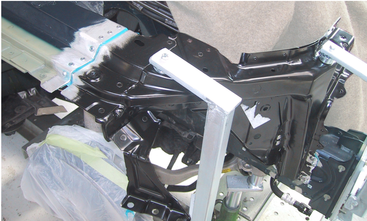
Bild 6: Ersatz Frontblech beim BMW 5-er mittels Nieten und Kleben (Bild Flückiger)
