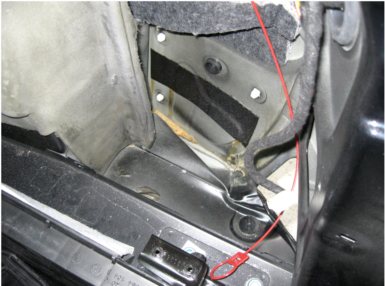
Deformierte Innenbleche (Bild Flückiger)
