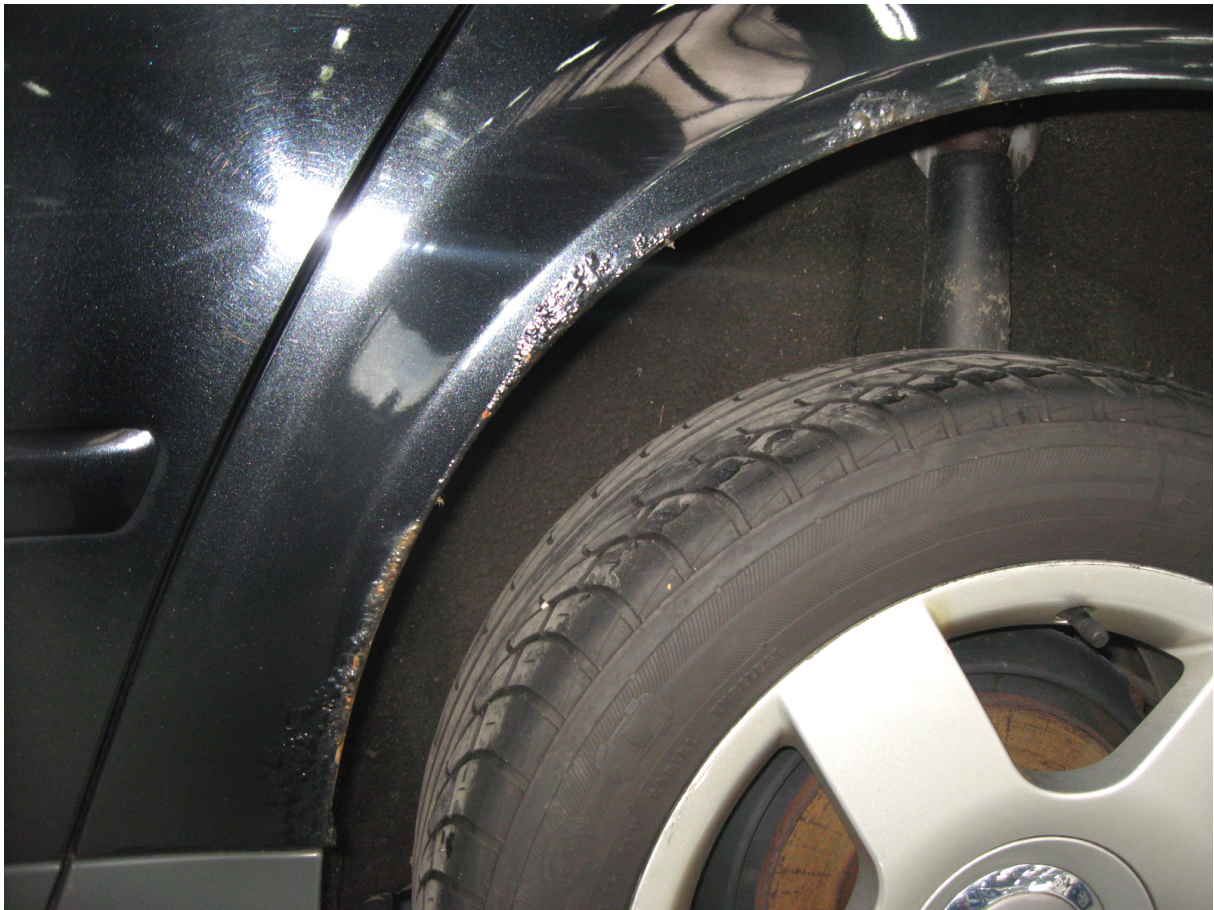
Auswirkungen einer mangelhaften Instandsetzung (Bild Flückiger)
