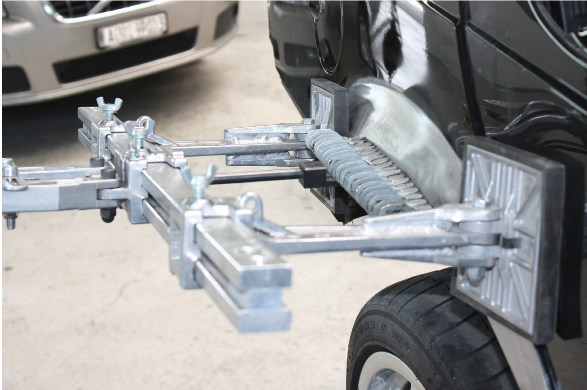
Bild: Ausbeulen mittels Push-Pull-System (Bild Flückiger)
