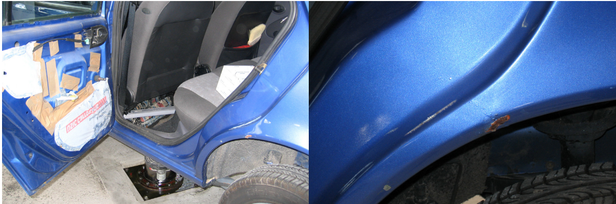
Abschnittsreparatur mit korrodiertem Übergang (Bild Flückiger)
