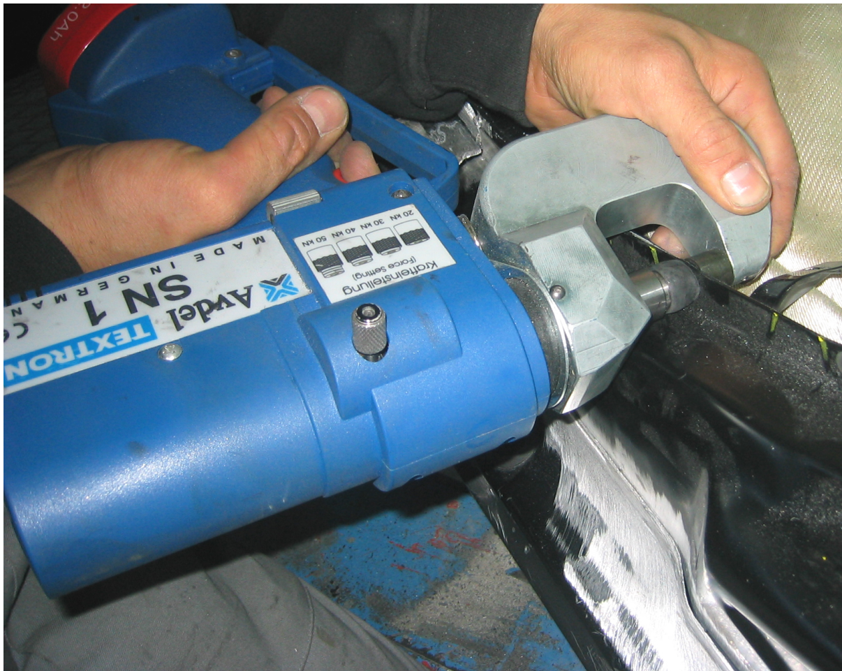
Bild 5: Ersatz Seitenwand beim Audi A 8 (Bild Flückiger)
