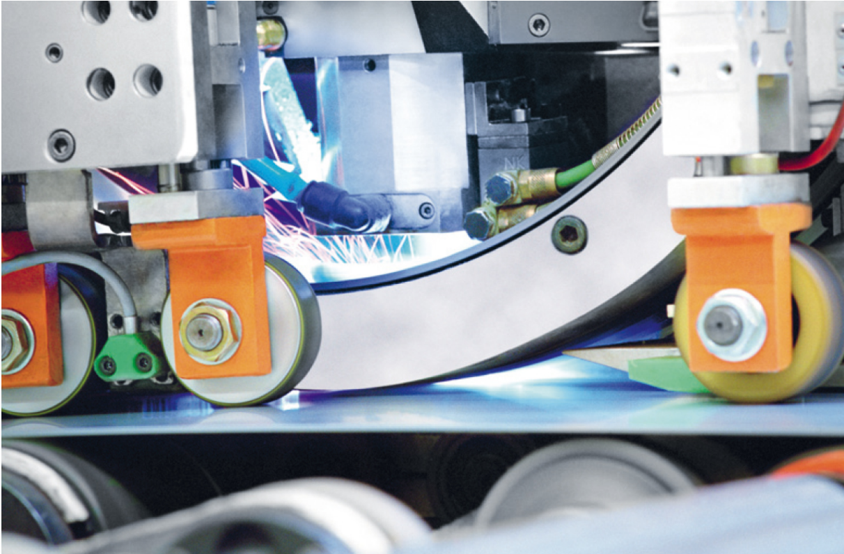
Bild 3: Tailored Blanks werden aus unterschiedlichen Güten mittels Laser geschweisst (Quelle: ThyssenKrupp)
