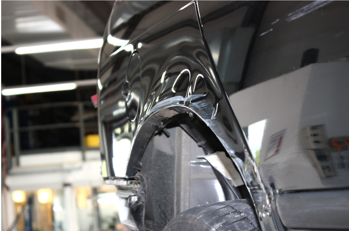
Bild: Die stark deformierte Seitenwand (Bild Flückiger)
