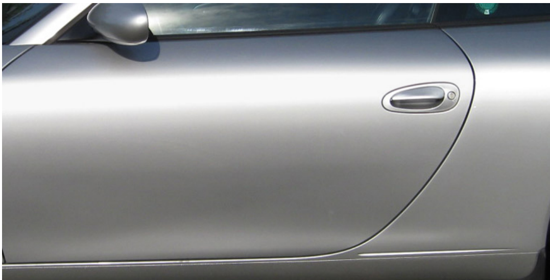
Obwohl die Türe nur mit Klarlack überzogen wurde, ist eine Differenz feststellbar (Quelle Flückiger)
